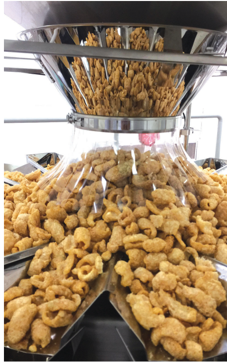
Tinitimbang saka isinasalang sa makina ang chicharron bago ito dumaan sa packaging. (Mga larawan mula sa DOST-X)
