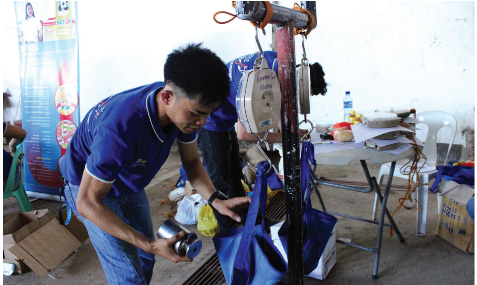
Ikina-calibrate ni Jerald V. Esmeralda, isa sa mga staff ng RML ng DOST-X RSTL, ang isa sa mga 62 hanging-type weighing scale ng BNS at health centers ng Misamis Occidental.
