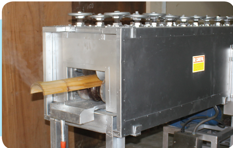
Ang bamboo flattening machine ng FPRDI. (Larawan mula sa DOST-FPRDI)
